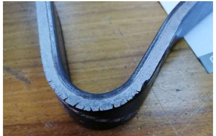
شكل (5) يوضح اختبار الثني بمعمل T.S19 توضح ظهور التشققات عند الثني غير الكامل للعينة
