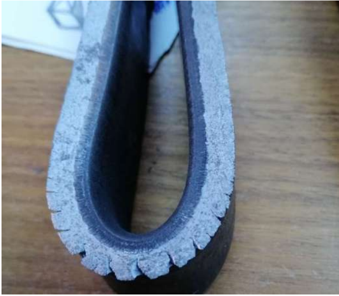
شكل (6) يوضح اختبار الثني بمعمل T. S19 زيادة نمو التشققات عند الثني بزوايا 180 درجة للعينة
